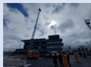
この度、富士吉田消防署のはしご車が南関東防衛局の補助を受け、27年ぶりに更新配備されました。地上35mまで伸長可能で、コンピューター制御が進み、近代的かつ最新鋭の装備を有し、先端屈折式となっているため要救助者救出へのアプローチが直近まで行くことができます。
